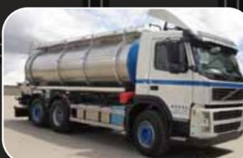
Cisterna para transporte y limpieza de agua a presión, mediante un sistema neumático incorporado parte delantera y trasera del vehículo.
