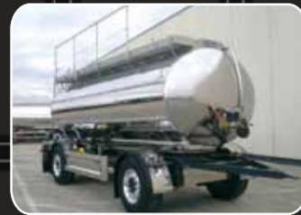
Cisterna con chasis autoportante más lanza con o sin refuerzo, para ejes separados de dos o tres ejes.
